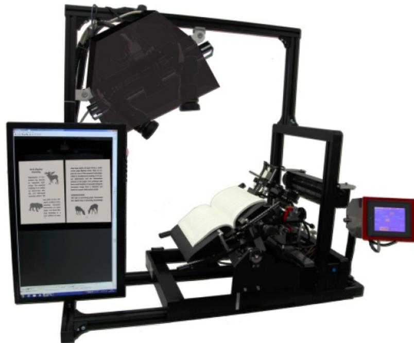
撮像された画像と同時に取得した3次元形状を用いて、変形する前の平面の書籍画像に復元する独自の補正技術を開発
