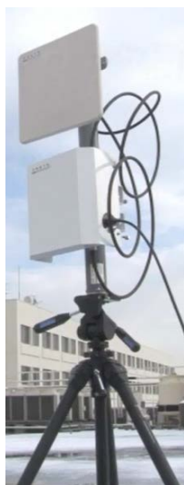
災害時に電話やWi-Fiなどの 通信機能を確立出来る 可搬型ICTユニット(上)とIP 無線装置(左) 【富士通(株)】
