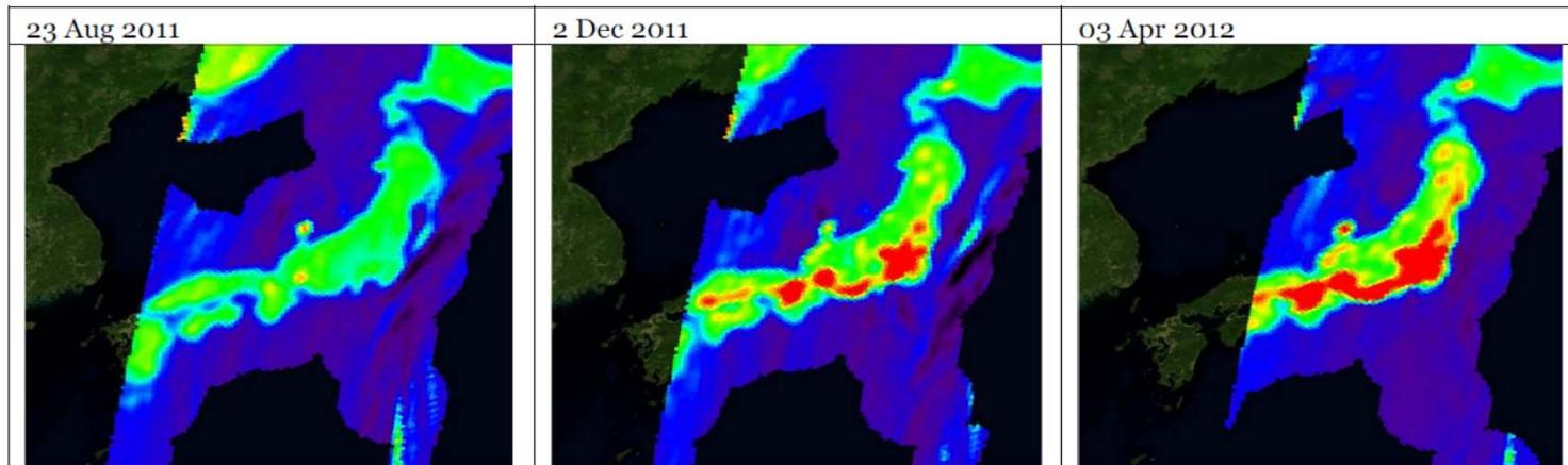
ESALレポート“Analysis of the impact of BSAT-3C emissions into the RF interference detected by SMOS satellite over Japan”より、雑音の主たる原因として衛星放送用受信設備からの電波漏洩が指摘された。
