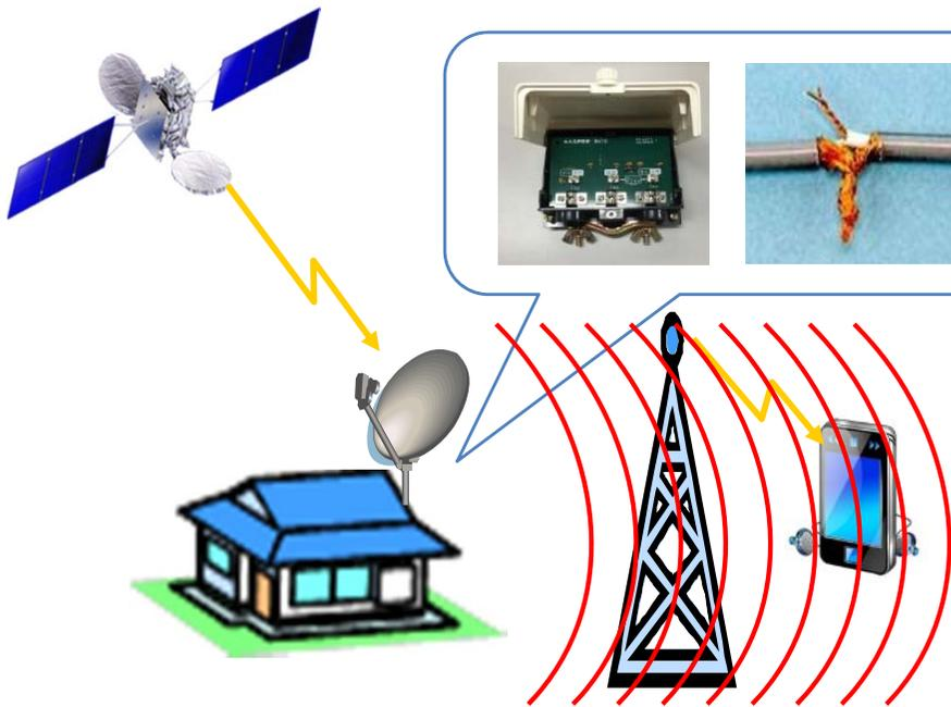
我が国で市販されている衛星放送受信機は、取り扱いを容易にするため、アンテナで受けた電波(12GHz帯)を、低い周波数(中間周波数(IF)~2GHz帯)に変換し宅内に引き込む。
