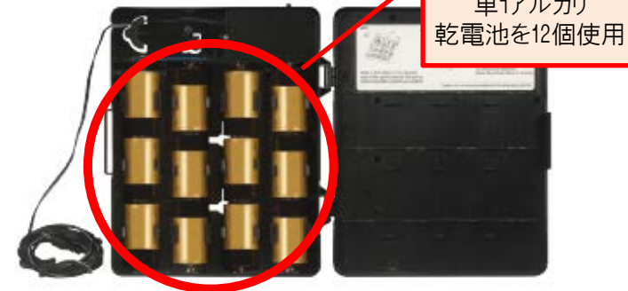
電源ボックスの内部(乾電池収納部)
