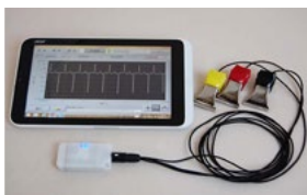
▲開発した血中Ca濃度解析システム （上：受信解析端末、下：Bluetooth 式 心電アンプ）。
