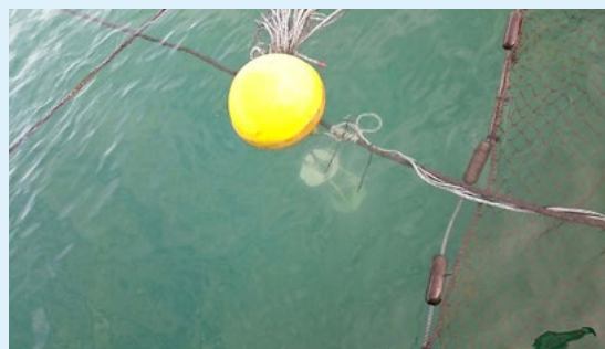
現在開発中の漁業を支援するための海中センサ 海中に設置されたセンサが、魚群の様子、潮流や海水温の変化などのデータをネットワークシステムに送る。データは漁船などに送られ、漁業に生かされる。
