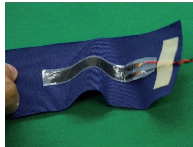
ジャージに貼り付けた柔軟膜伸長センサ
