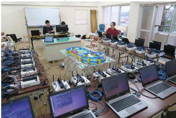
図 B 開発した統合センサネットワークシステムと屋内測定実験の様子
