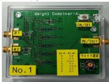
図 3 比率可変型電力分配合成回路
