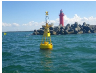
灯浮標(工事区域明示用)
