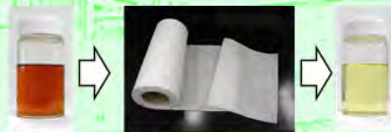
廃油 → グラフト触媒 → ディーゼル燃料 グラフト重合でバイオディーゼル用触媒を開発
