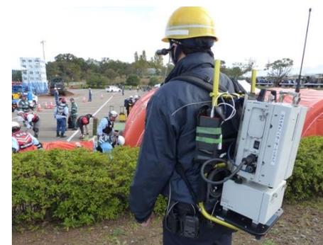
公共ブロードバンド移動通信システムを用いた情報収集の実演
