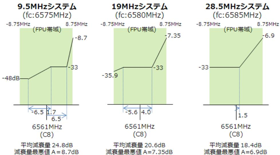
図 1 5 ㊦ F P U 帯域内（チャンネル C8）への干渉波漏洩電力
