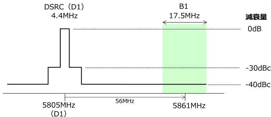
図4 規定より仮定したスペクトルマスクと隣接するFPUのチャンネル (B1) との関係
