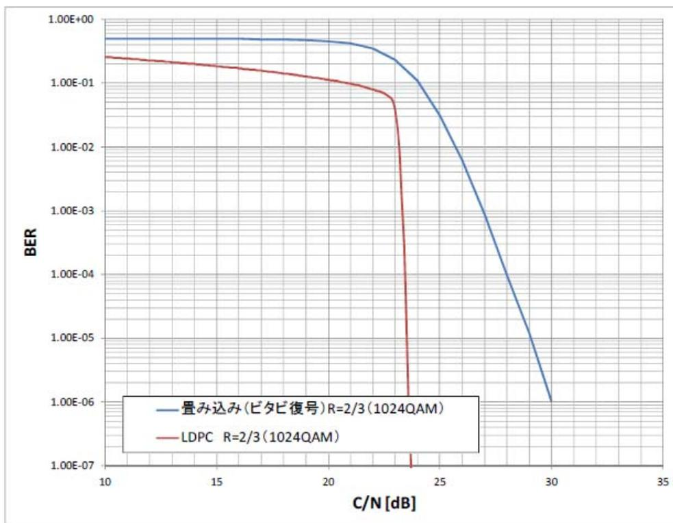
図 1 1024QAM-OFDM 方式のビット誤り率特性の例
