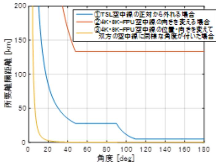
図3. 12 空中線の向きを考慮した所要離隔距離（TSL と同一チャンネルで、固定中継（高品質伝送）モデルの場合）
