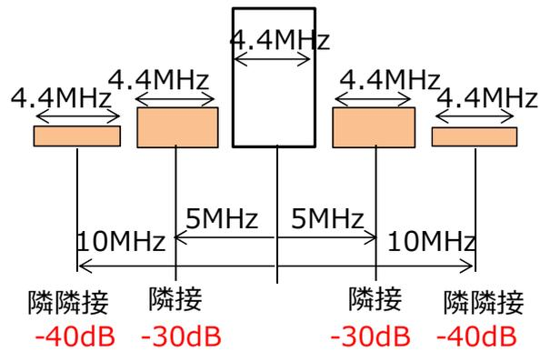
図1 DSRC の隣接チャンネル漏洩電力の規定
