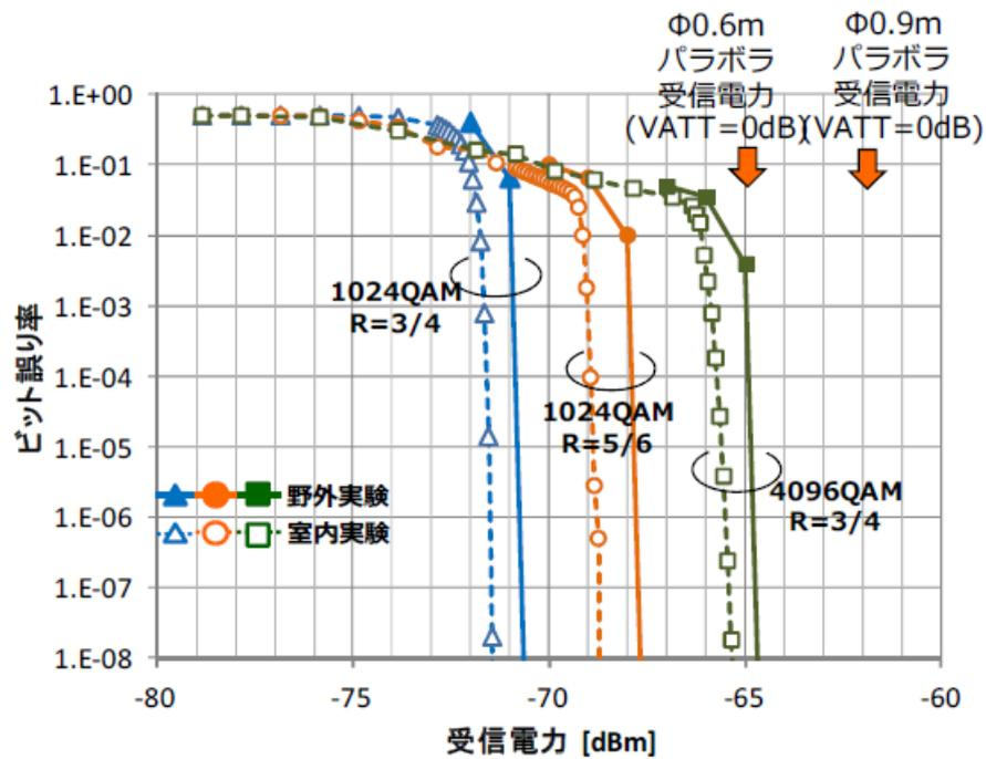
図2 ビット誤り率の測定結果
