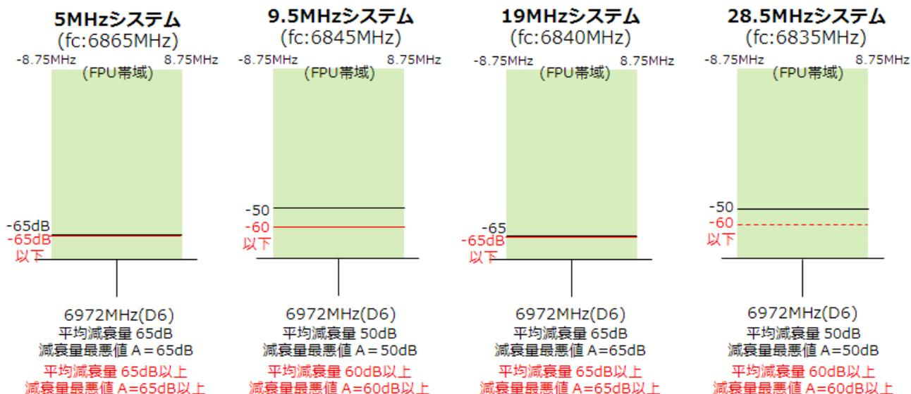
図 18 ㊦ FPU帯域内（チャンネルD6）への漏洩電力
