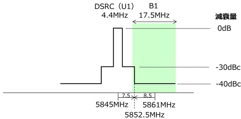
図3 規定より仮定したスペクトルマスクと隣接するFPUのチャンネル (B1) との関係
