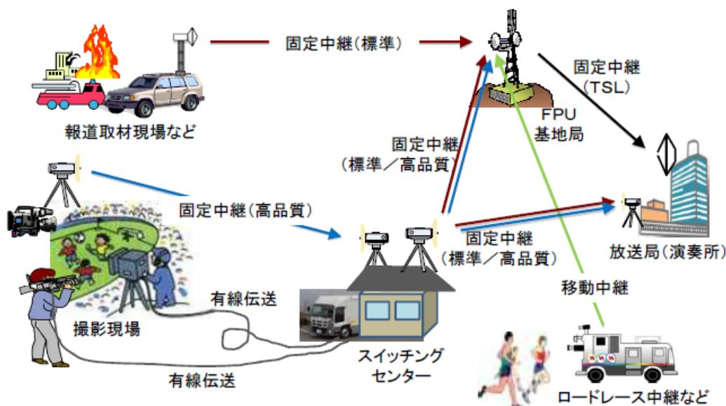
図1 4K・8K用FPUの想定される運用モデルのイメージ
