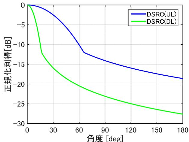
図2 DSRC 移動局、基地局の想定空中線放射パターン
