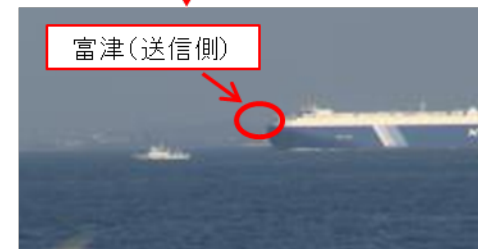
12:49 大型船舶通過による 約1dBのレベル低下
