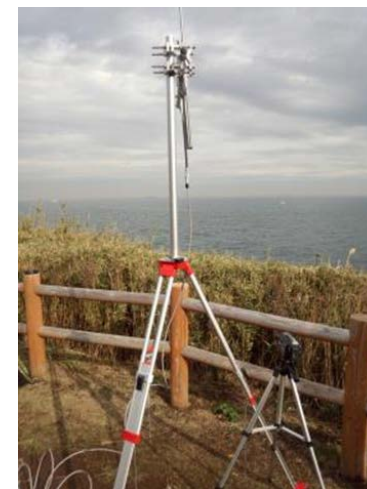
八木アンテナでの環境雑音測定風景
