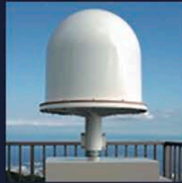
ゲリラ雷雨をもたらす積乱雲を捕捉する「WITH レーダー」
