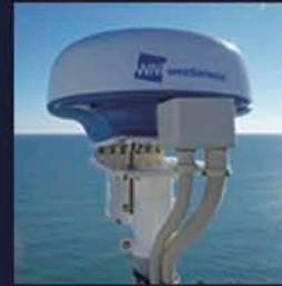
沖合約30kmの津波を捉える「TSUNAMI レーダー」
