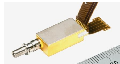
図3: (三菱)製品化した小型波長多重技術を適用した100Gbps光インターフェース
