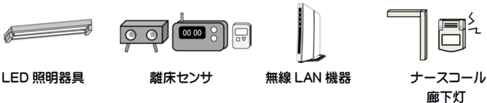
注) 医用テレメータの周波数帯(バンド3の3000番台のチャンネル)は、テレコンテレメータとして、他に無線式ナースコールや介護病棟の離床センサ、さらにはクレーンのリモコンなどにも使われているので、十分な注意を払わないと思わぬ混信トラブルを招く。
