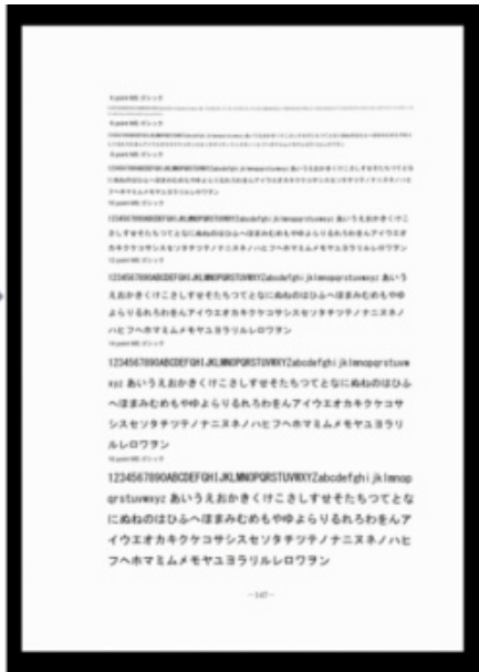
撮像された画像と同時に取得した3次元形状を用いて、変形する前の平面の書籍画像に復元する独自の補正技術を開発
