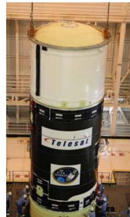
組み立て中のH-IIA29号機。 長時間飛行に備え、太陽光入射による機体温度上昇を抑えるために2段機体白色塗装をするなど、性能向上のための工夫が施されている。
