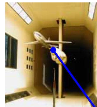
スティング支持装置
