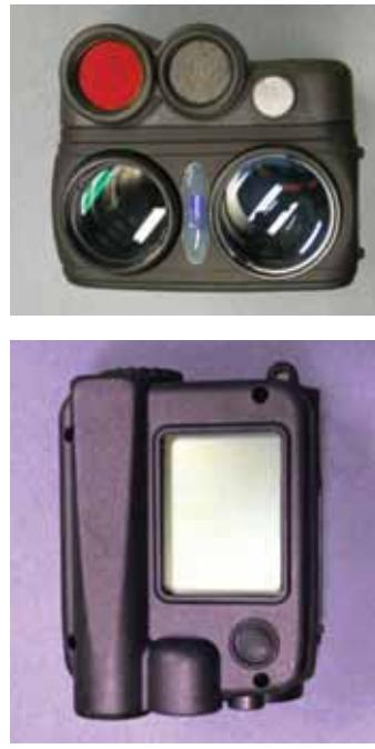
レーザー測高器 2 : バーテックスレーザー (音波計測機能も併せ持つ)
