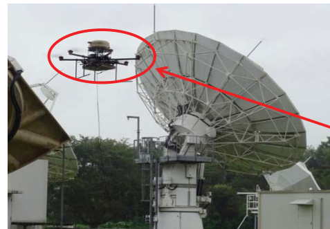
衛星通信アンテナを搭載したドローン (実験の様様)
