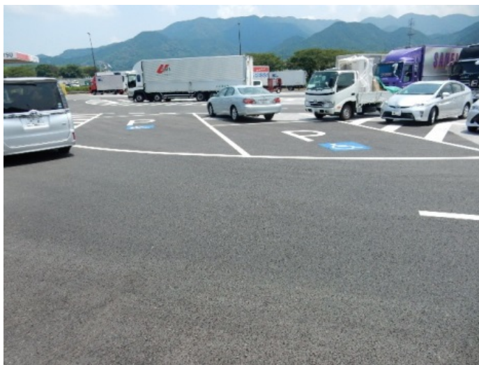
写真2 休憩施設を利用するため車両の通行帯を横切る必要がある障害者用駐車場
