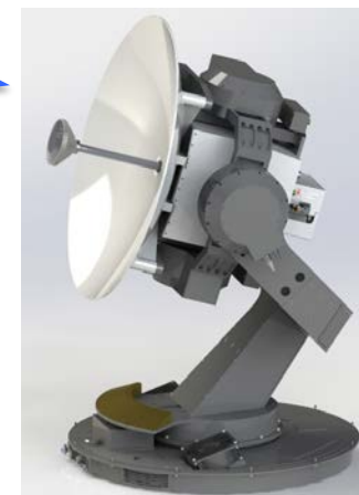
総務省プロジェクトでNICTが開発中の調査船用小型地球局 (完成イメージ)
