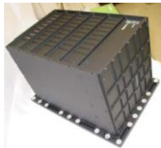
衛星搭載交換機
