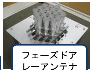
デジタルビーム形成回路＋アレイアンテナ試作(20-30GHz)
