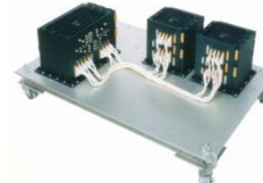
高速パケット通信用 搭載交換機
