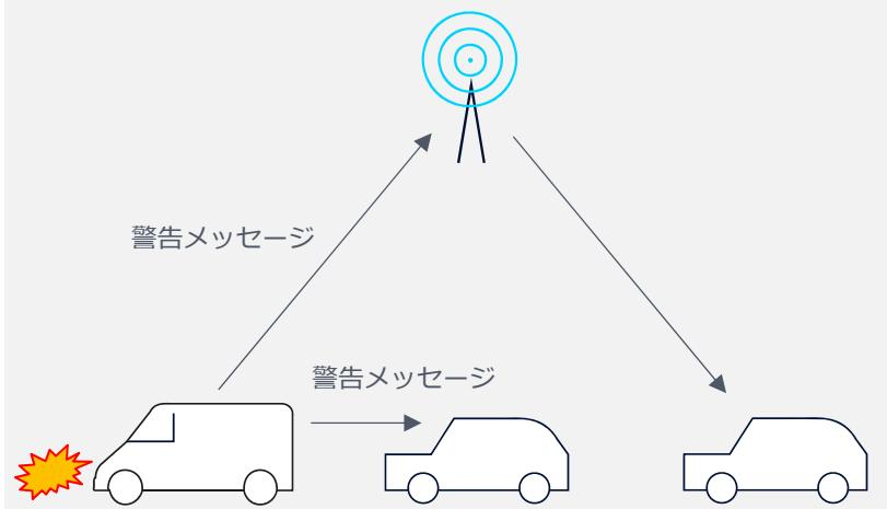
WAVE / ETSI ITS 標準が制定; LTE V2V は3GPP リリース14 にて標準化済み
