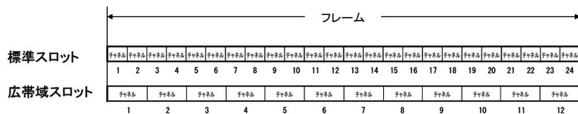
図 5. 1-2 DECT 方式のフレーム構成
