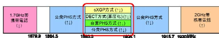
図4. 2-1 1.9GHz 帯の帯域内の共用システム
