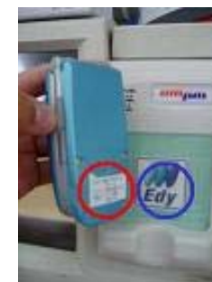
RFID機器 125kHz、13.56MHzがある (高周波利用設備に該当する機器もある)
