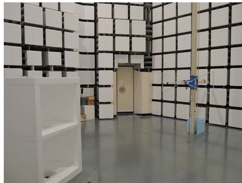
(2) 電波半無響室 (Semi Anechoic Chamber)
