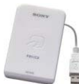
RFID機器 125kHz、13.56MHzがある (高周波利用設備に該当する機器もある)
