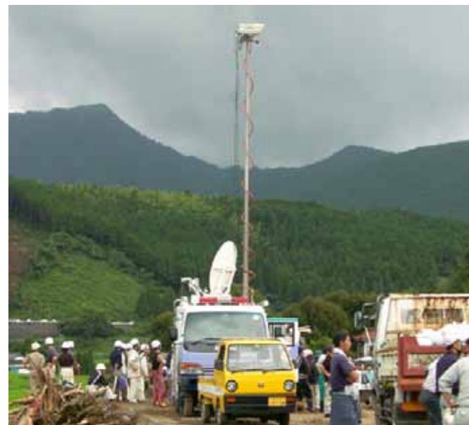
土石流現場衛星通信車
