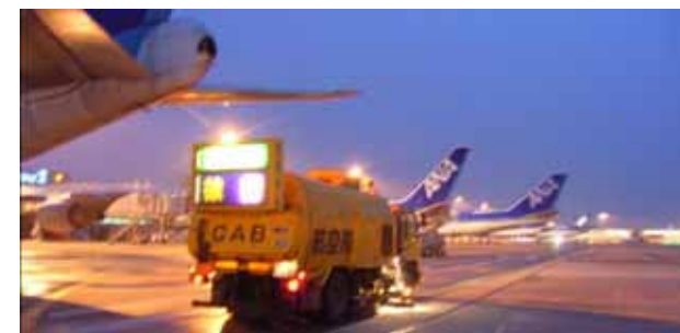
(舗装面清掃:航空機エンジンへの吸い込みを防止するために、路面の異物や土砂等を回収・処分)
