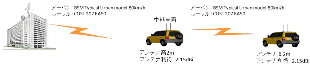
図2. 2. 4-2 陸上多段中継利用：周波数チャネル分割制御方式（2分割）の構成例
