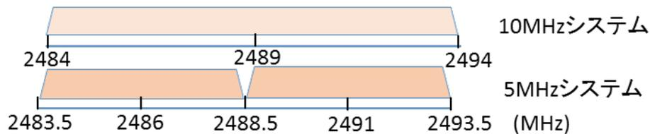
図 2.7 2.4GHz帯ロボット用無線システムのチャンネル配置
