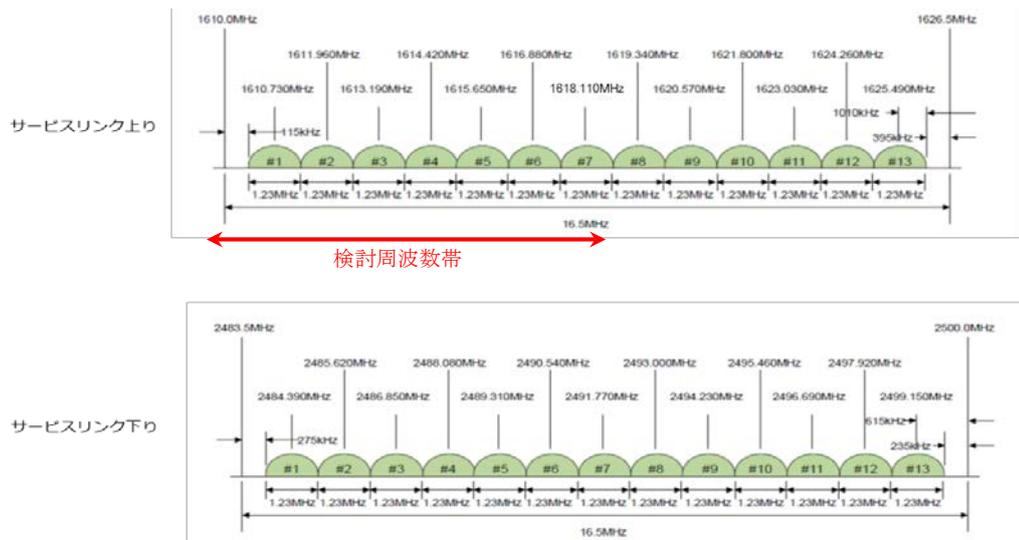
図 2.3 グローバルスター衛星通信システムのサービスリンク用波数配置
