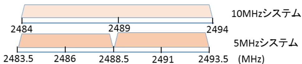
図参 5-1 2.4GHz帯ロボット用無線システムのチャンネル配置
