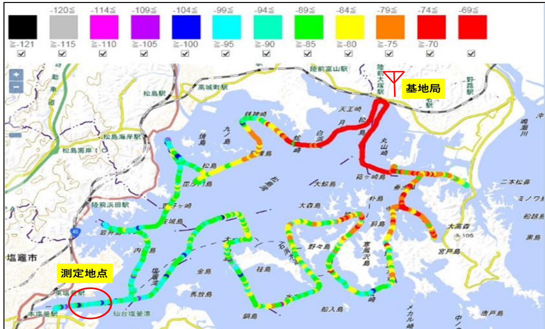
図 3-2. 車載型無線機における電波受信電力レベルプロット図
