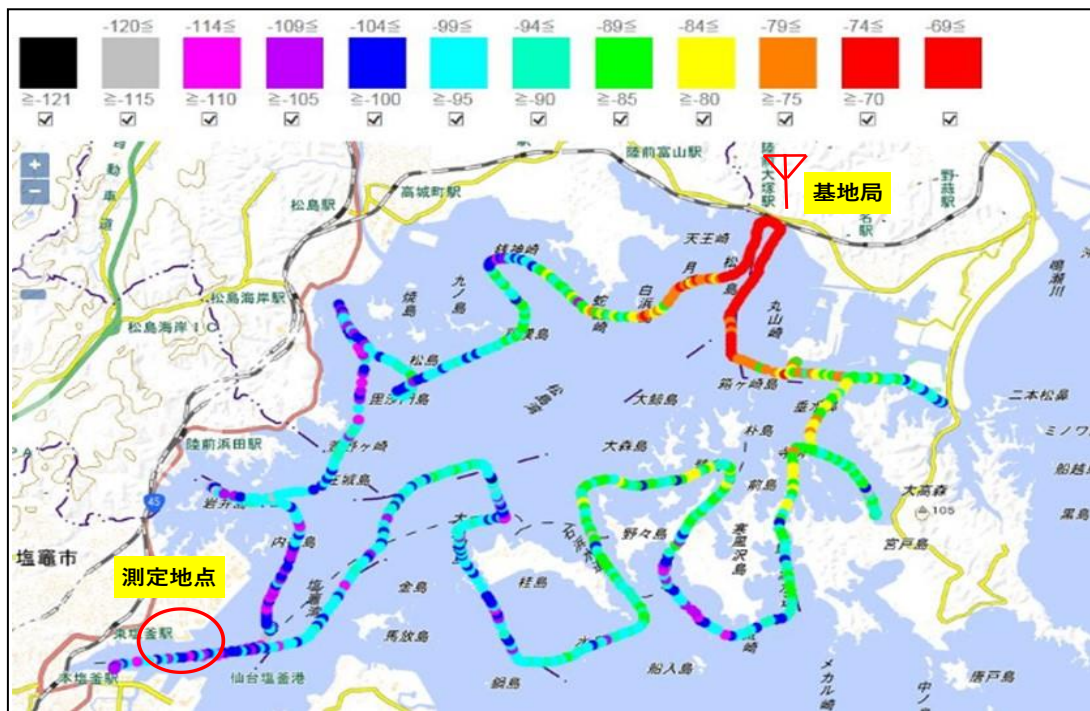
図 3-3. 携帯型無線機における電波受信電力レベルプロット図
