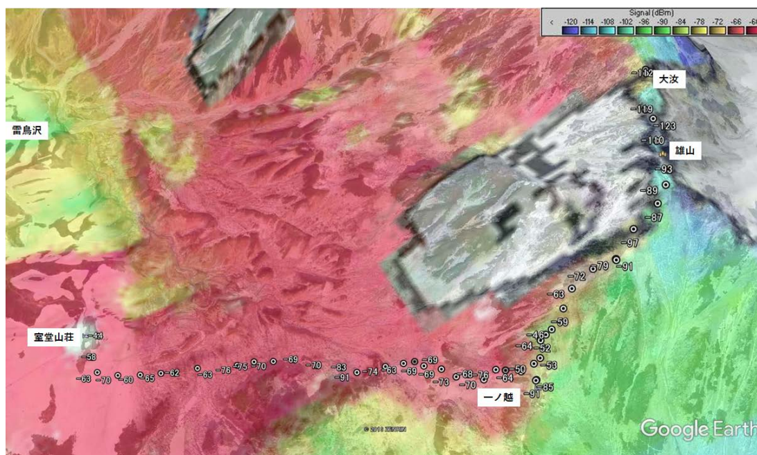
図 3-38 立山室堂山荘検知局で検出した登山者位置情報・電波強度を電波伝搬シミュレーション結果にプロットした図(室堂山荘ー一ノ越ー大走)
