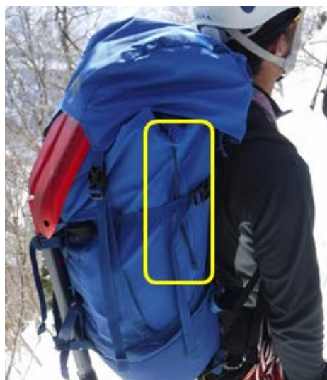
(a) 登山者携帯端末のアンテナの固定場所 (b) 救助要請信号を送信時の様子 図 3-25 山岳警備隊による評価試験の様子 (写真提供 富山県警察山岳警備隊)
