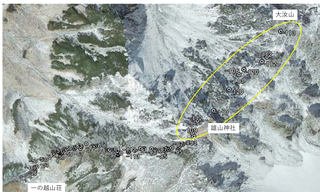
図 3-15 一の越山荘検知局による一の越～雄山～大汝山の登山道を移動する登山者から発信された電波の受信強度(RSSI 値)
