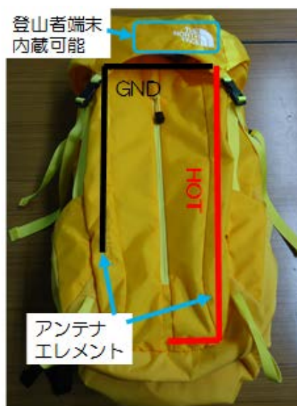
図 2-3 アンテナ内蔵ザックの外観
