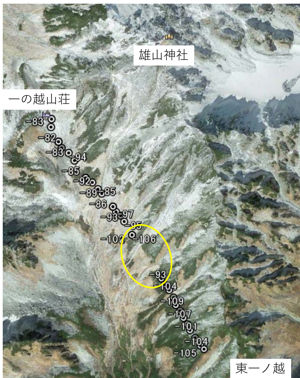
図 3-18 雄山移動検知局による東一ノ越方面の登山道を移動する登山者から発信された電波の受信強度(RSSI 値)
