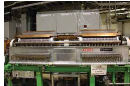
シンクロトロンRF加速部
