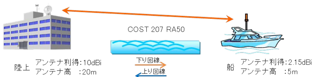
図参 2-24 港内での利用を想定した回線設計の基本モデル
