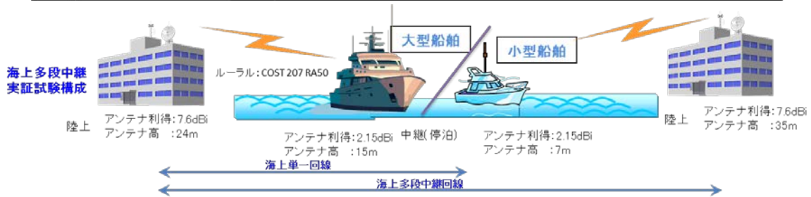
図参 9-1 実証試験の構成例（海上多段中継利用）
