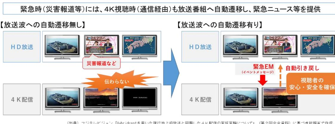
図 28 イベントメッセージ (EM) を利用した放送画面への引き戻し方式の概要
