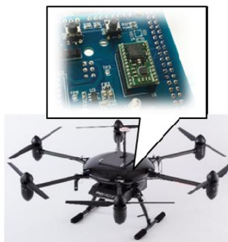
ドローンの実機写真と搭載された秘匿暗号化回路
