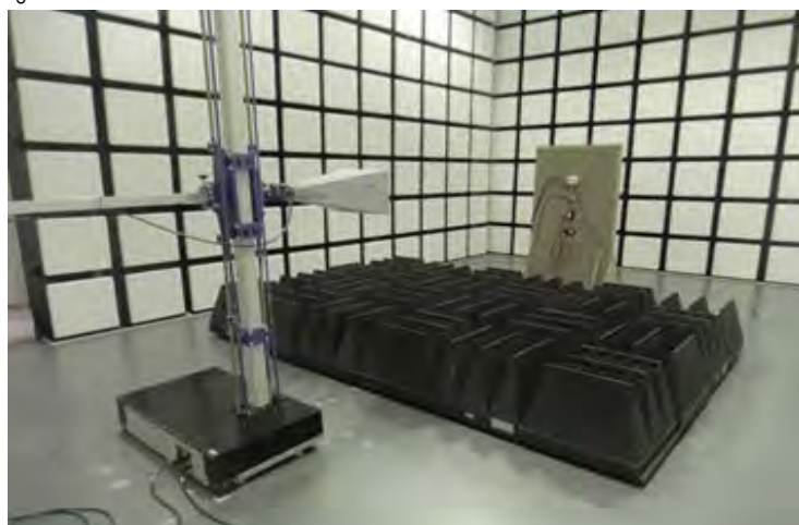
図 27 戸建住宅モデルの機器の配置
