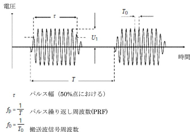
図E.4 測定用受信器に入力されるパルス変調RF信号
