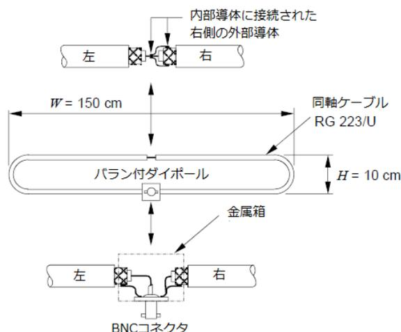
図 C.9 バラ付きダイポールの構造
