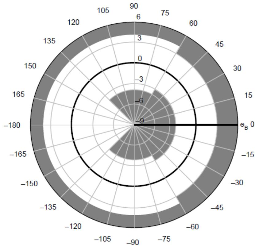
図 19-b 6 GHz から 18 GHz の放射パターンの例
