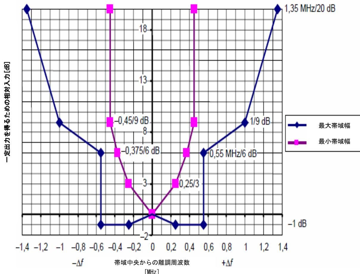
注 1) インパルス帯域幅に関する許容範囲は、この図には表わすことができない。なぜなら、インパルス帯域幅はフィルタの型に依存するためである。したがって、6 dB 及び 9 dB 帯域幅に対する境界は、参考として示す。
