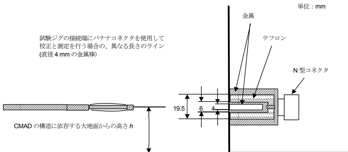
注) 垂直フランジの底面は金属大地面に電氣的に接合されている。
