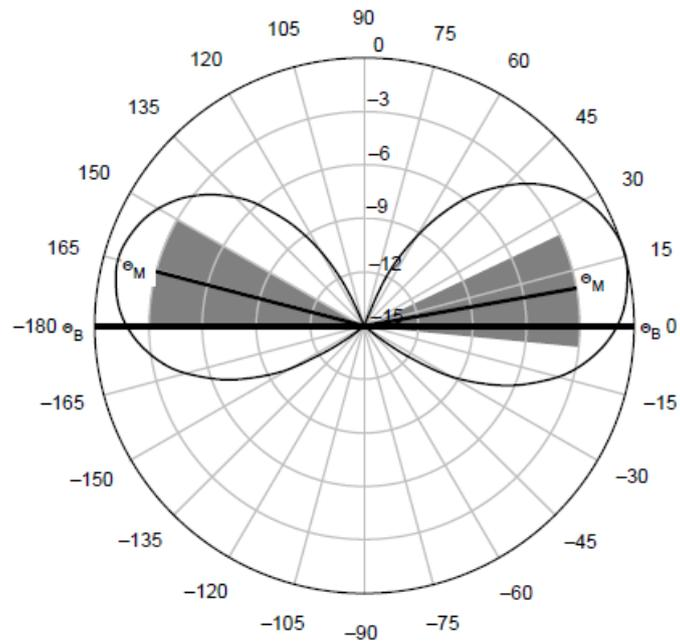
注) このプロット例は、本節の E 面要求条件を満足するアンテナに対するものである。右及び左側の放射パターンの主ローブ方向  $\theta_M$  は、それぞれ、 $0^\circ \pm 15^\circ$  及び  $180^\circ \pm 15^\circ$  の間にある。影付きの領域は禁止帯を表し、そこでは、各々の主ローブ方向の  $\pm 15^\circ$  に対して振幅が  $-3$  dB 以下である。アンテナパターンは、禁止帯に入っていない。
