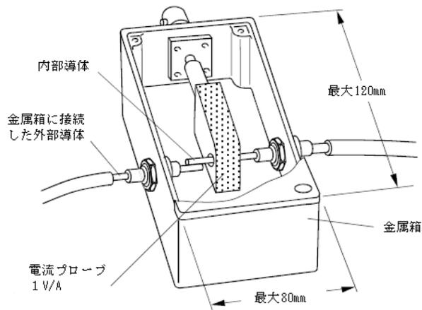
図 C.5 電流プローブを内蔵する金属箱の構造
