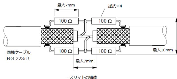
図 C.4 アンテナスリットの構造
