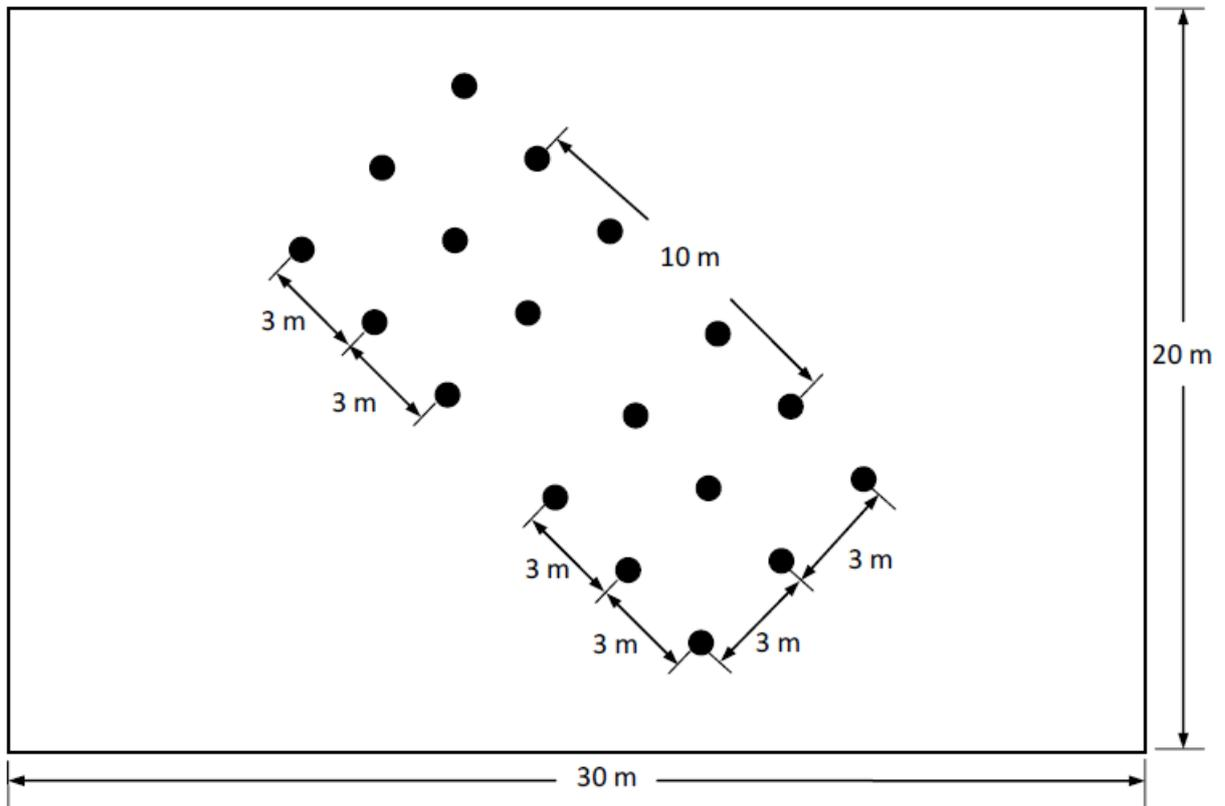
図 33 10 m のテスト距離のペアテスト箇所の選択の例
