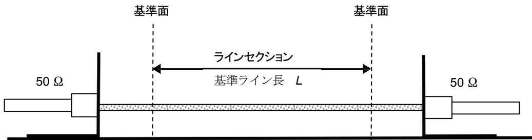
図 24d 「線路」の校正測定系の構成
