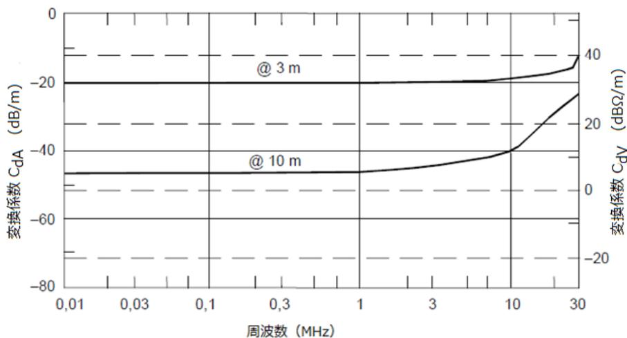
図 C.10 2つの測定距離  $d$  に関する変換係数
