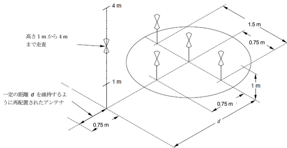
$d$ =アンテナ中心と受信アンテナ中心の垂直投影との間の距離
