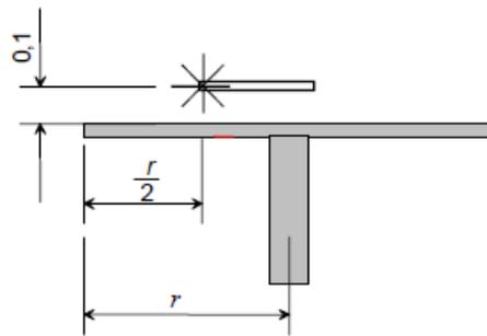
図 15 試験台上のアンテナ配置(側面図)
