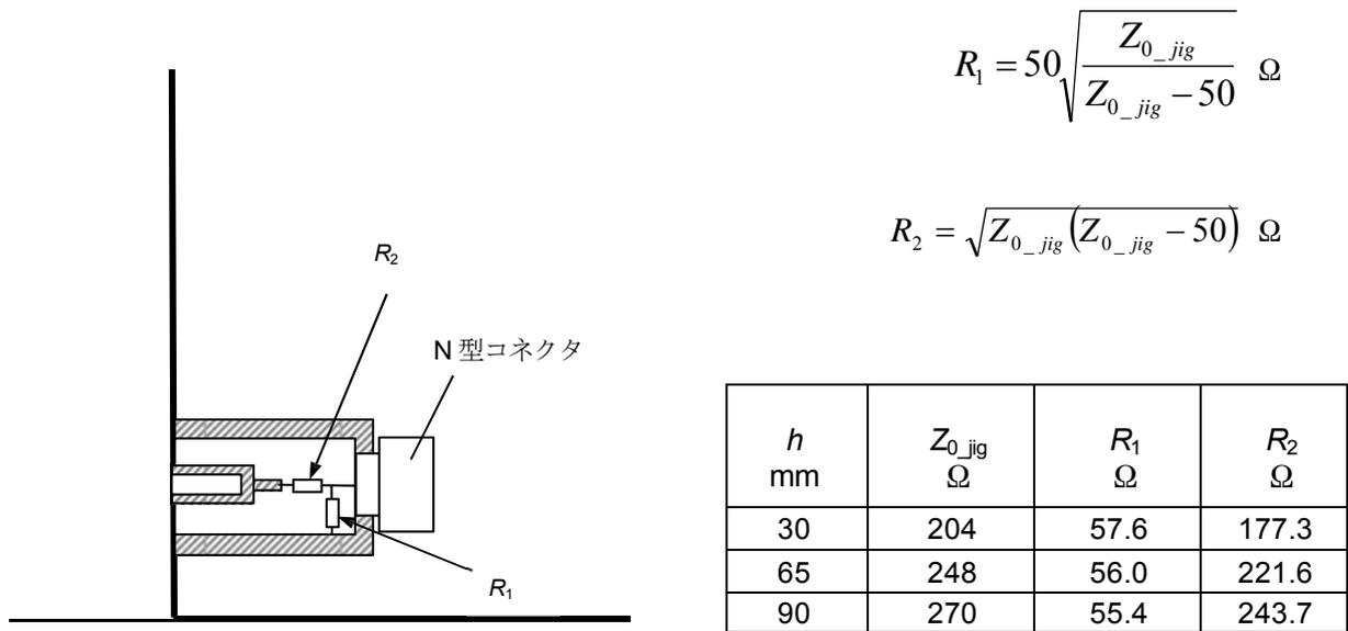
図 28 抵抗を用いた整合回路を有する整合アダプタの例
