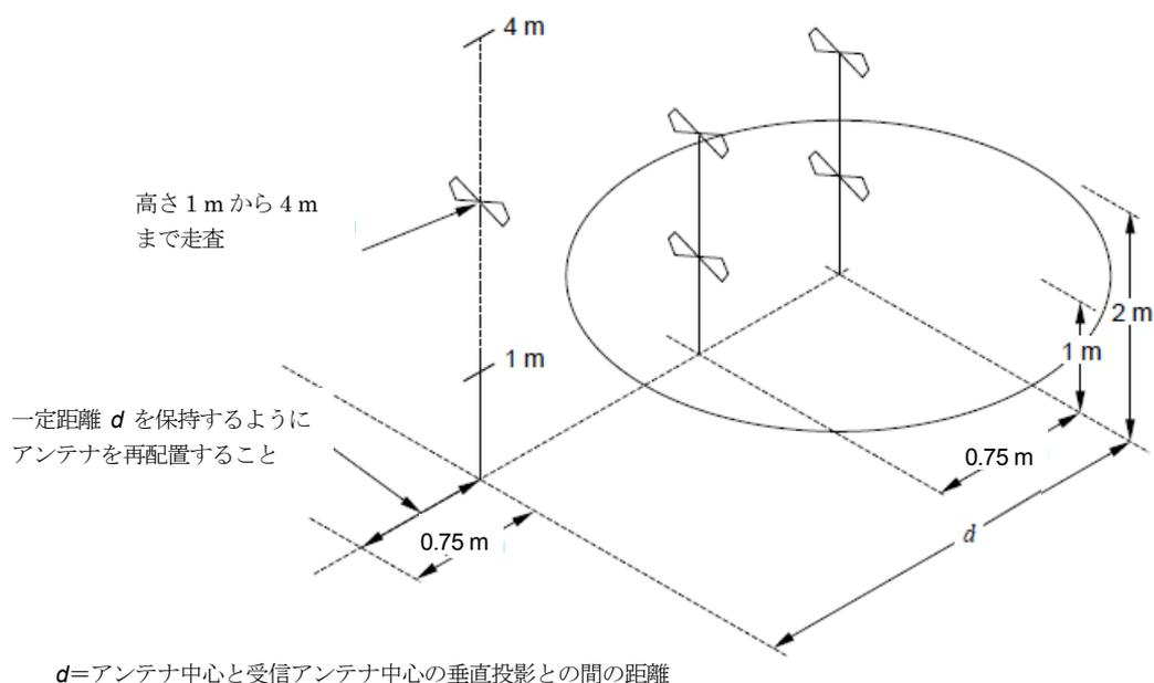
$d$ =アンテナ中心と受信アンテナ中心の垂直投影との間の距離
