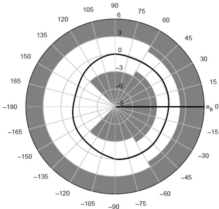
図 19-a 1 GHz から 6 GHz の放射パターンの例
