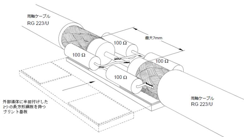
図 C.4 頑丈な構造を得るためにプリント回路基板に取り付けたアンテナスリット構造の例
