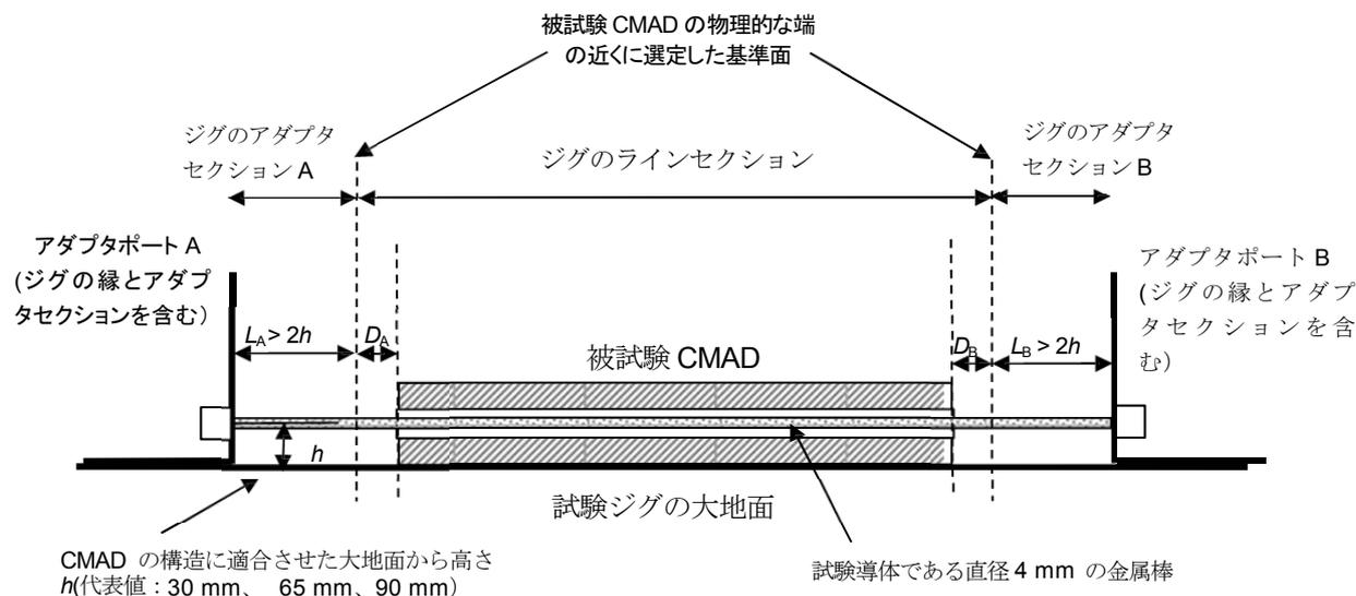
図 23 試験ジグ内部の基準面の定義
