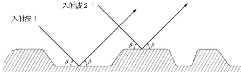
図 D.1 大地面の凹凸に関するレイリーの粗さの基準
