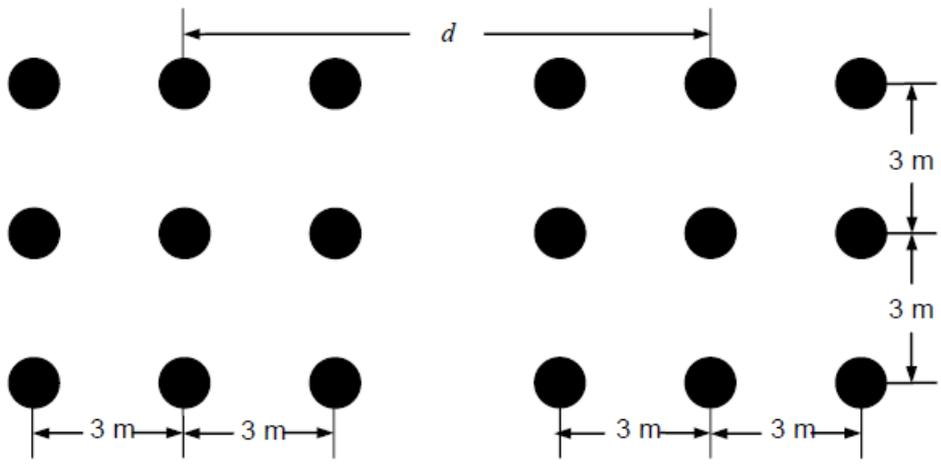
$d$ は、2つのアンテナの基準点間の距離
