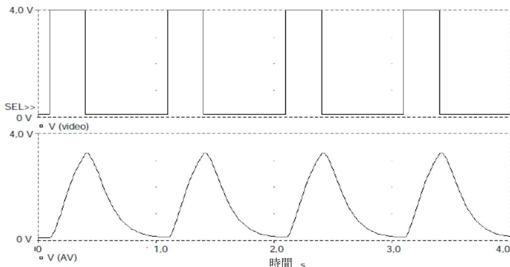
注1) ここに示す応答は、時定数 100 ms を用いたとき、パルス幅 0.3 s、繰り返し周波数 1 Hz の間欠的な狭帯域信号によって得られたものである。もし、時定数が 160 ms ならば、指示計模擬回路の出力の最大値はこれより低くなる。
