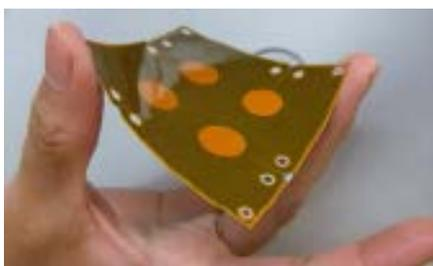
図 3-19 衛星本体に装着できる薄型アンテナ
