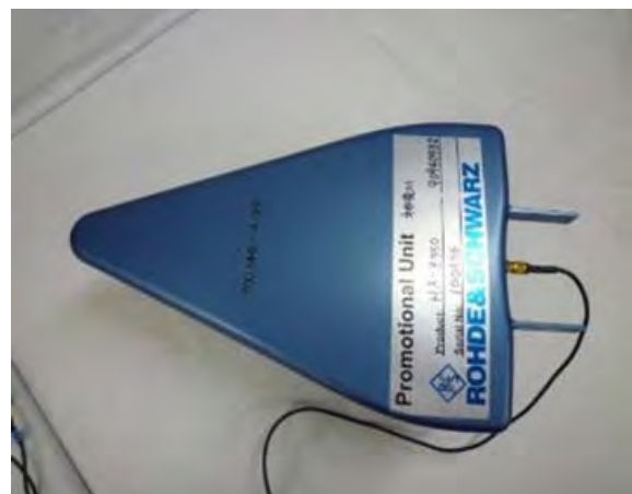
図 3.6 ログペリオディックアンテナの外観 (ローデシュワルツ社製の例)
