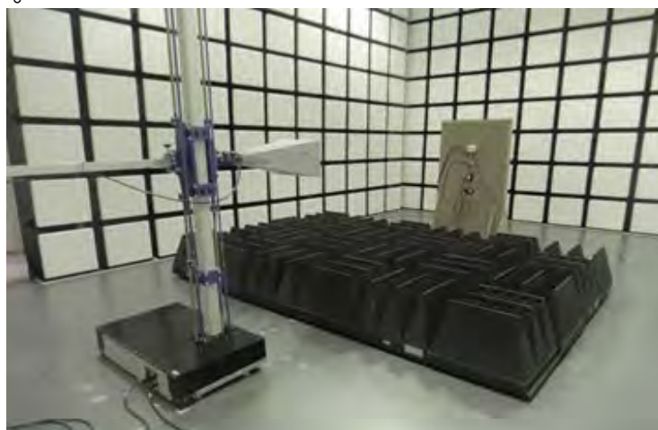
図 27 戸建住宅モデルの機器の配置
