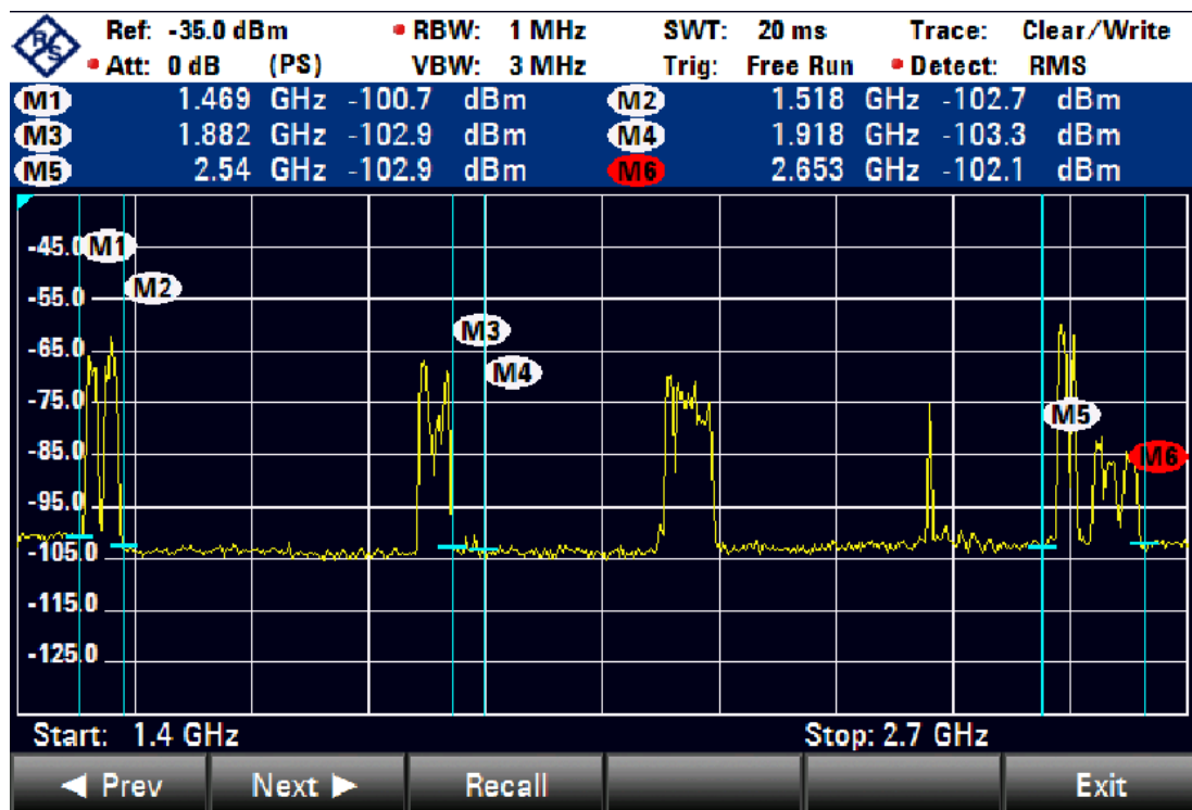
(アンテナ:ダブルリッジホーンアンテナ 測定器:可搬型スペアナ) 図 3.3 実際のフィールドにおける 1.4GHz~2.7GHz までのスペクトラム波形
