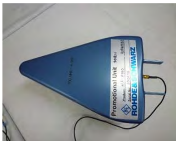
図 3.6 ログペリオディックアンテナの外観 (ローデシュワルツ社製の例)
