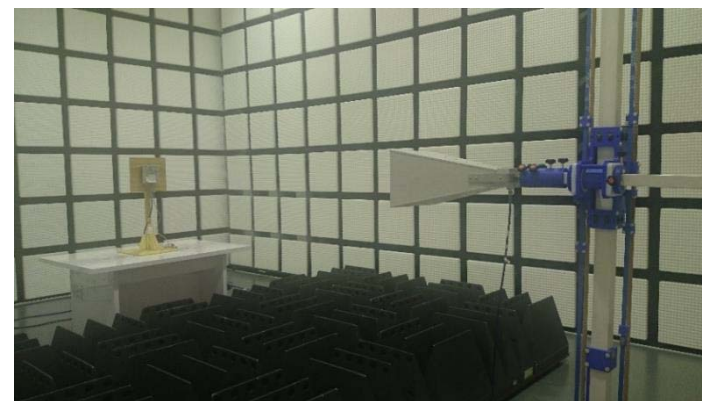
【漏洩電波の測定風景】
