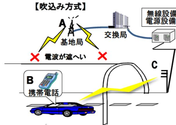
注：無線局Aと無線局Bとの間の電波が遮へいされるため、無線局Cを設置することによりトンネル内での通信を可能とする。
