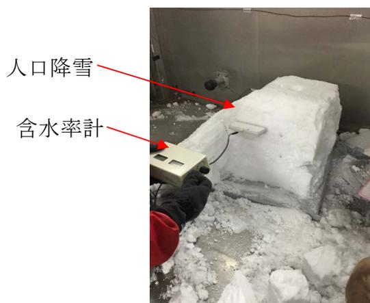
図 3.1.18 測定の様子 (含水率の測定)
