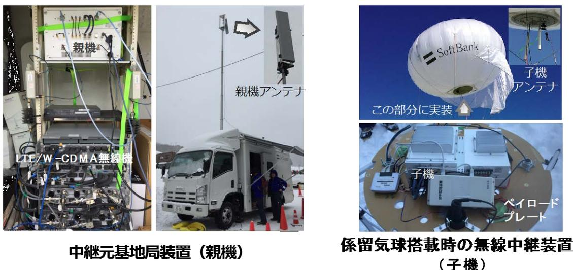
図 3.1.35 中継元基地局装置（親機）と無線中継装置（子機）の外観
