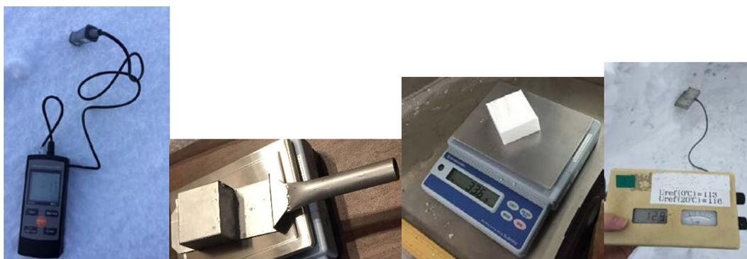
(a)温度計 (b)スノーサンプラー (c)質量計 (d)含水率計
