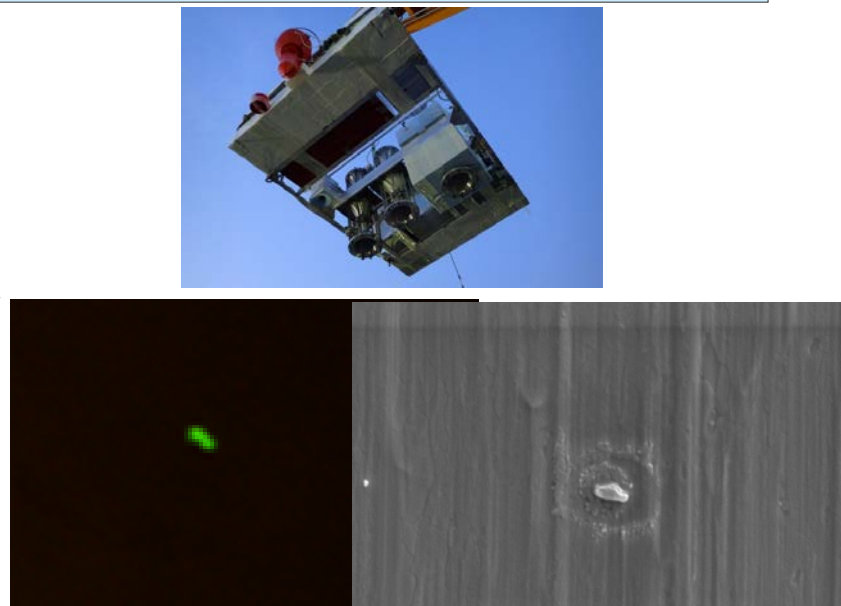
成層圏微生物採取実験装置(上)と採集された微生物の蛍光顕微鏡写真(左下)および成層圏エアロゾルの電子顕微鏡写真(右下)
