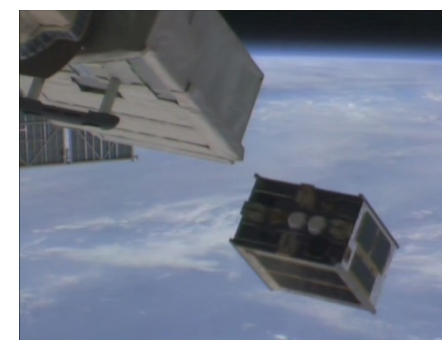
小型衛星放出機構から放出されるDIWATA-1(フィリピン/東北大/北大)
