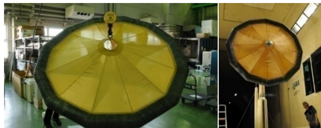
←プロトタイプモデルの耐空力荷重試験（低速風洞試験）の様子
