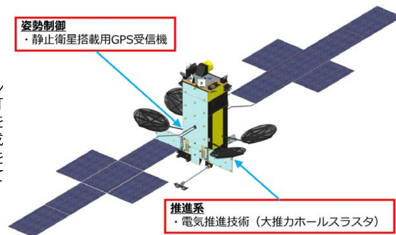
技術試験衛星9号機の概要と研究開発成果の適用先
