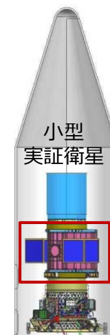
フェアリング内部 (複数衛星搭載状態)
