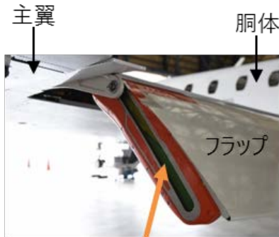
フラップ作動用の溝 想定外の騒音が発生したが 原因説明と対策設計が完了
