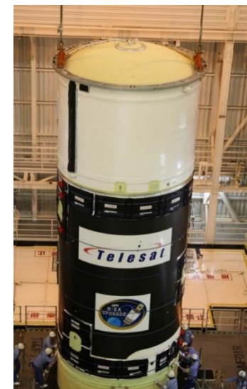
組み立て中のH-IIA29号機。長時間飛行に備え、太陽光入射による機体温度上昇を抑えるための2段機体白色塗装となっている。(打上げ性能向上のための工夫)
