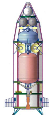
検討中の小型実験機 (全長：7m、全備質量：2.5トン)
