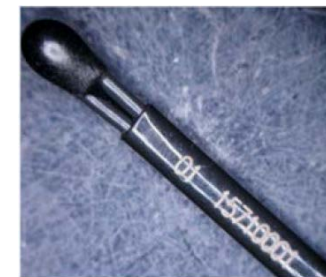
リード形サーミスタ （写真の1辺が約10mm）
