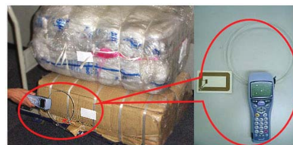
圧縮された廃棄プラスチックブロックの写真 廃棄プラスチックを圧縮機で圧縮梱包し、梱包ブロック単位でICタグを貼付している
