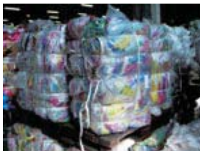
圧縮された廃棄プラスチックブロックの写真 廃棄プラスチックを圧縮機で圧縮梱包し、梱包ブロック単位でICタグを貼付している
