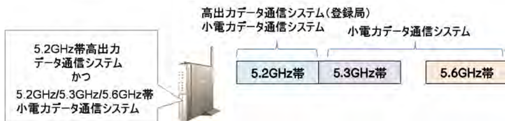
図 5.1.4-1 5.2GHz 帯高出力データ通信システムと小電力データ通信システムが一体となっている無線設備
