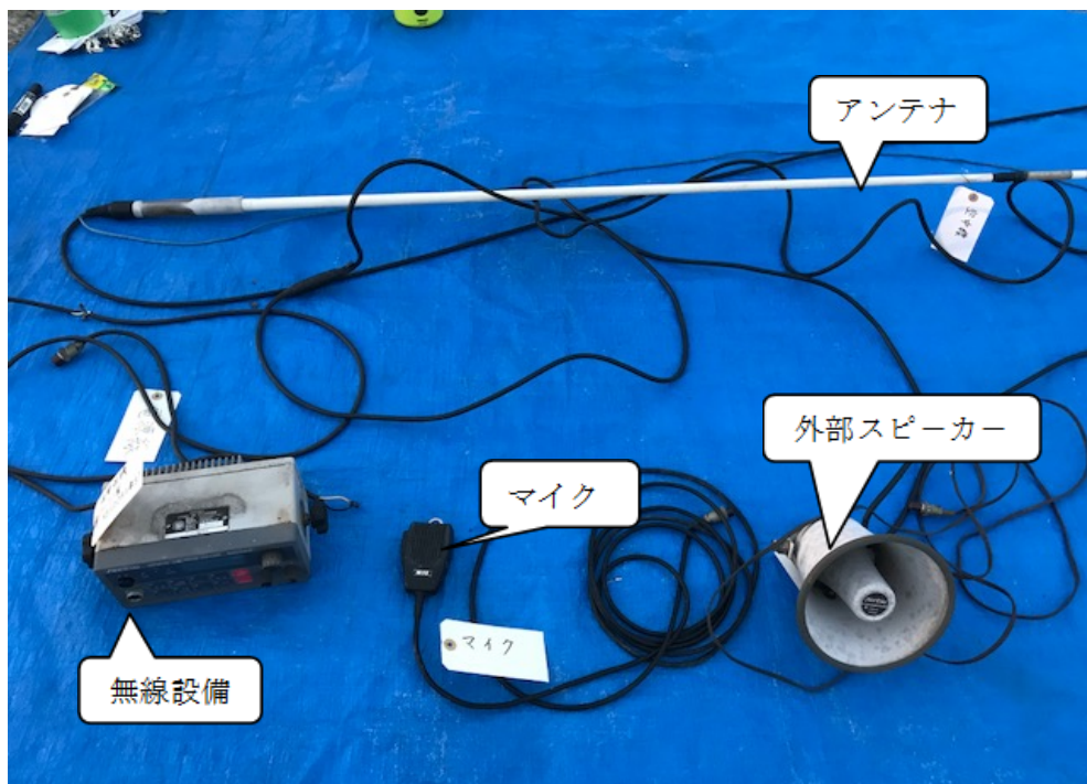
＜船舶に設置されていた不法漁業無線設備＞
