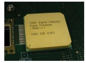
100G光伝送用信号処理チップ (NTT、NEC、Fujitsu、三菱電機)
